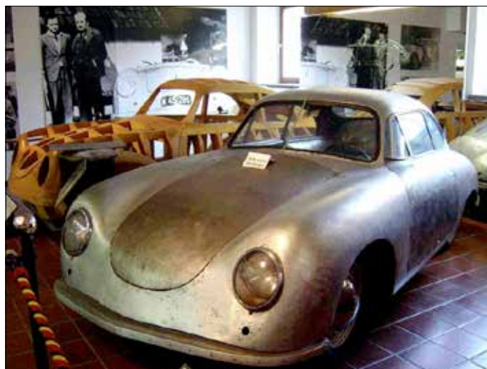
Hliníková karoserie Porsche 356 a za ní stojící dřevěné kopyto
